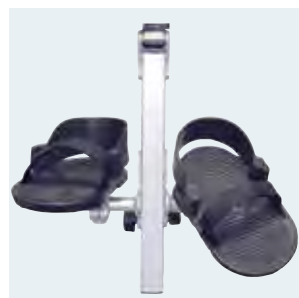
Cod. 873121-2 Pedana divisa Unità posturale per arto inferiore con poggia piedi diviso, inclinabile, con regolazione indipendente in altezza, divaricazione, flesso-estensione e intra-extra rotazione. Dotata di cinturini fermapiède e fermatallone.
